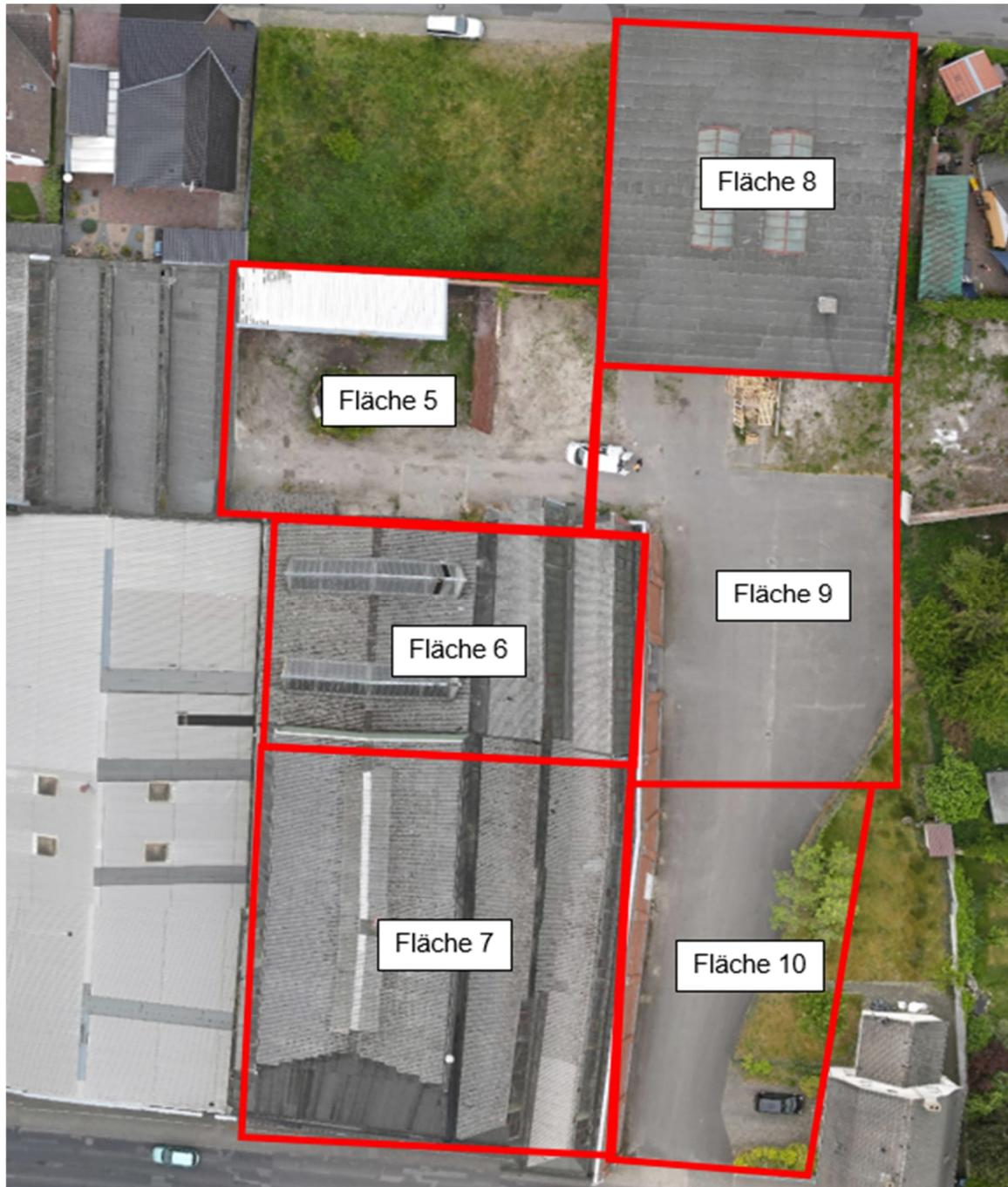
Von den Flächen 5 – 10 sind je Fläche 20 Sondierungen erfolgt, aus denen je Fläche die Horizonte 0,0 – 0,1 m, 0,1 – 0,3 m und >0,3 m bis in den gewachsenen Boden beprobt wurden. Die Ergebnisse finden sich in den nachfolgenden Tabellen.
